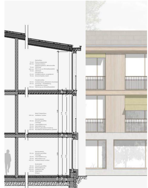
Konstruktionsschnitt Perimeter A
